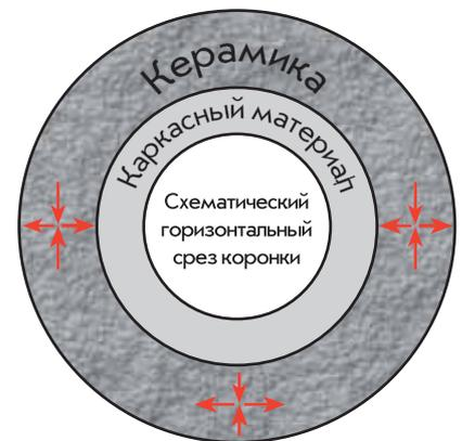
Идеальное распределение тангенциального напряжения растяжения и сжатия имеет место, когда КТР керамики оптимально соотносится с КТР каркасного материала.
