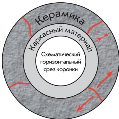
Если КТР каркасного материала **значительно ниже** КТР облицовочной керамики, то тангенциальное напряжение растяжения повышается и вызывает радиальные микротрещины, направленные к поверхности. Это может привести к поздним трещинам.
