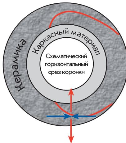
Если КТР каркасного материала **значительно выше** КТР облицовочной керамики, то тангенциальное напряжение сжатия повышается и вызывает микротрещины, проходящие почти параллельно каркасу. Это может привести к сколам керамики.
