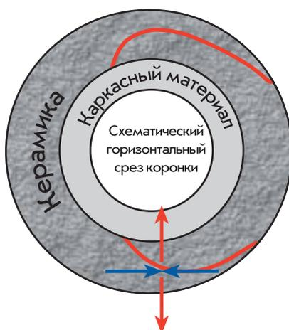
Если КТР каркасного материала **значительно выше** КТР облицовочной керамики, то тангенциальное напряжение сжатия повышается и вызывает микротрещины, почти параллельные каркасу. Это может привести к сколам керамики.
