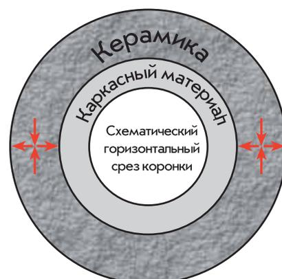
Идеальное распределение тангенциального напряжения растяжения и сжатия имеет место, когда КТР керамики оптимально соотносится с КТР каркасного материала. Тем самым предотвращается образование трещин.
