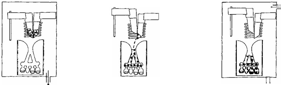
**1 фаза – сплав плавится под воздействием вакуума**
